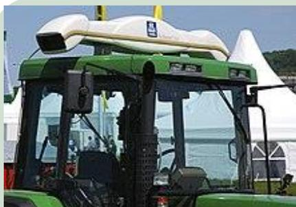
Sensore montato sul tettuccio di una trattore registra la luce riflessa dalla copertura vegetale, calcola gli apporti per la concimazione e varia la quantità di fertilizzante distribuita (**«N-Sensor ALS», Yara**)
